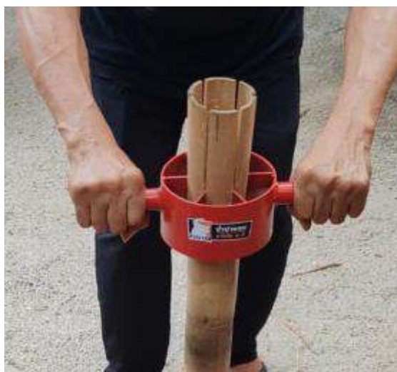
Figure 12 : Fabrication de lamelles en bambou
